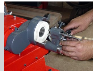
Retificação do pé da válvula c/ transferência de medida e uso de regulagem micrométrica
