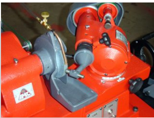
Retificação do rebolo c/ uso do dispositivo
