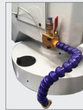
Refrigeração por névoa c/ar comprimido Refrigeración por névoa c/aire comprimido Mist cooling by compressed air injection
